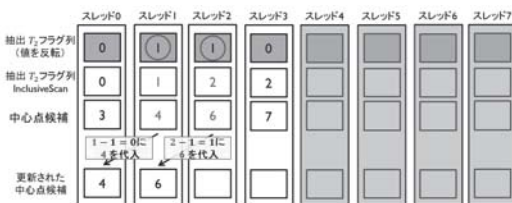
図 5: 中心点候補の更新 (2). 抽出 T_2 フラグ列と Inclusive Scan 後の抽出 T_2 フラグ列から, 中心点候補が更新後, どの位置に格納されるかが分かる. ここから, T_2 フラグが 1 になっている中心点候補を抜き出せる.
