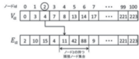
図 1 キャッシュヒットを考慮したデータ構造 Fig.1 Reconstructed data structure for CPU cache
