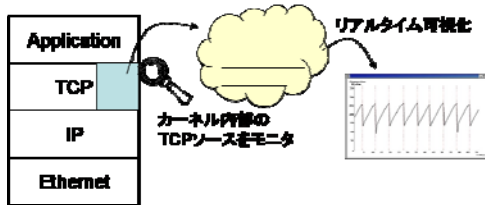
図6 TCP輻輳ウィンドウモニタツール Fig.6 TCP congestion window monitor tool
